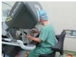
術者は、3Dモニターを見ながら操作します。指の動作と連動して動くロボット鉗子により直感的な手術操作が可能です。
